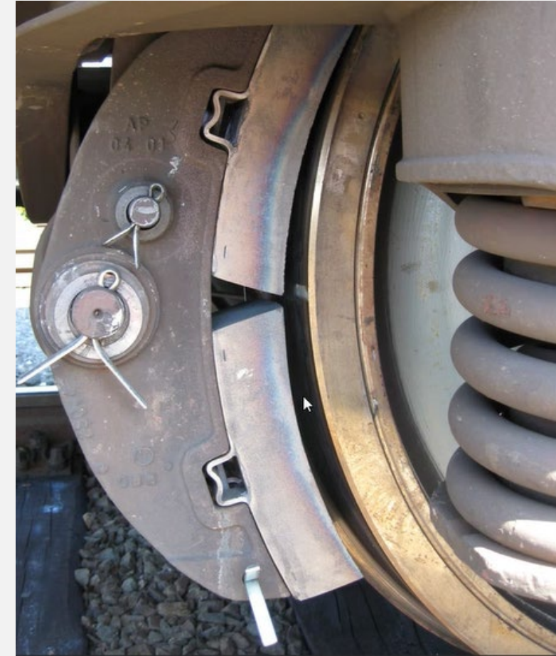
Gesinterte Bremsklötze: „Weiß-blaue Schicht“ auf der Reibfläche
