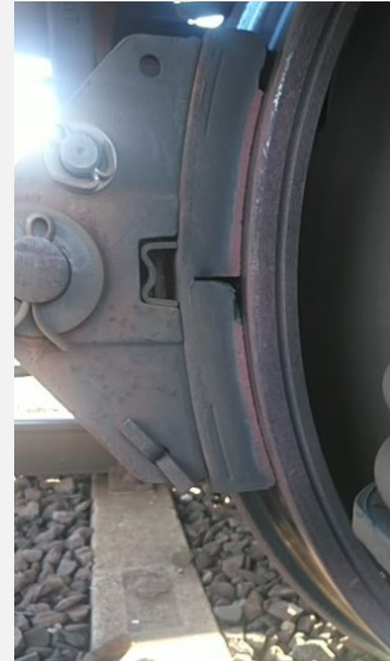
Organische Bremsbeläge: „Rote Schicht“ in der Reibfläche
