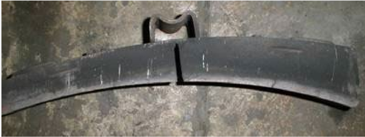
Organische Bremsbeläge: „Weiße Schicht“ auf der Reibfläche nahe der Oberfläche, Reibkohleablagerungen
