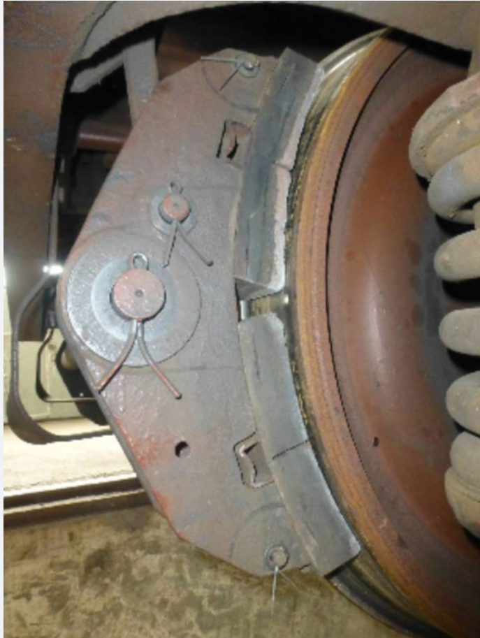
Grauguss-Bremssohle – Geschmolzene Bremssohle
