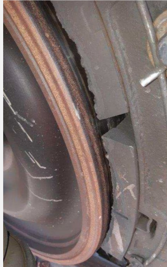
Alle Arten von Bremsklötzen: Abbröckeln der Reibfläche, große Reibkohleablagerungen
