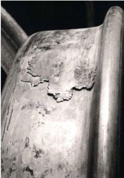
Metallauftragung auf der Lauffläche
